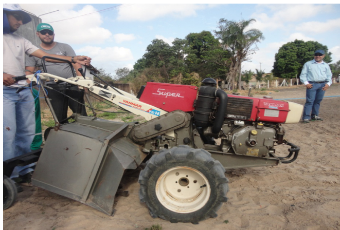
Figura 6. Microtrator utilizado para o preparo do solo na agricultura familiar.
