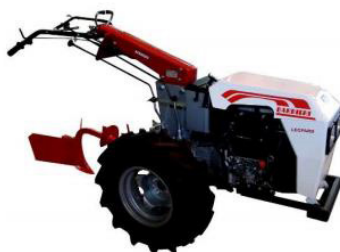
Figura 8. Arado para o preparo do solo, com tratores de rabiças. Fonte: Garcia (2004).
