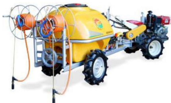
Figura 9. Pulverizador para tratores de pequeno porte para agricultura familiar. Fonte: Garcia (2004).
