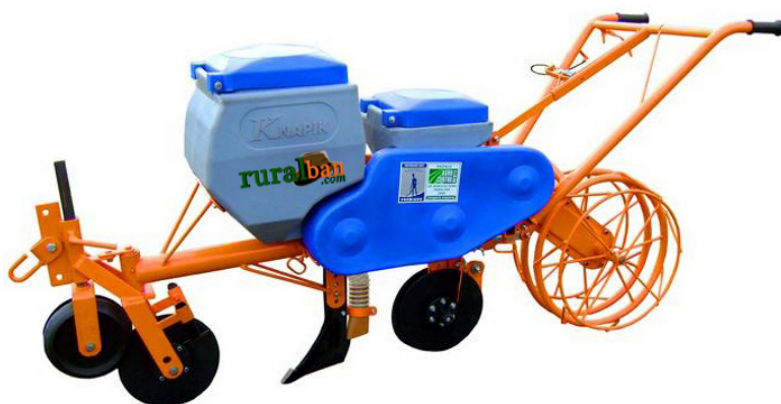
Figura 5. Semeadora de tração animal para plantio direto e convencional com haste sulcadora e discos duplos.
