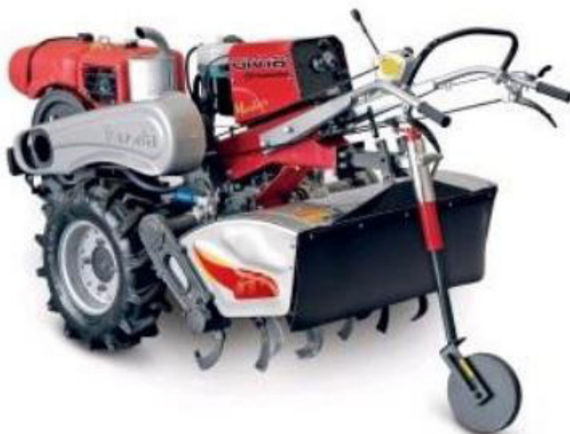
Figura 11. Enxada rotativa no preparo do solo com tratores de rabiças. Fonte: Garcia (2004).
