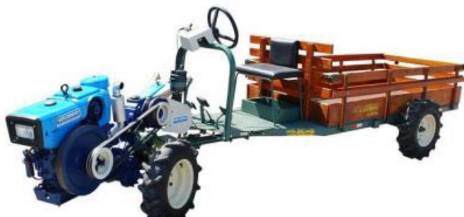
Figura 7. Carreta transportadora acoplada ao trator de rabiças Fonte: Garcia (2004).
