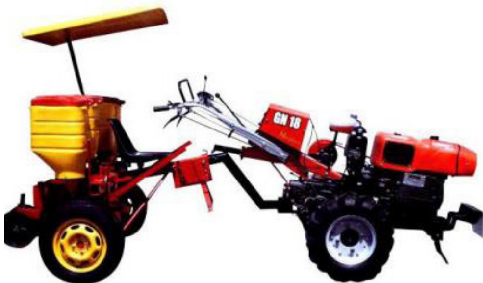
Figura 10. Semeadora para microtratores utilizadas na agricultura familiar. Fonte: Garcia (2004).
