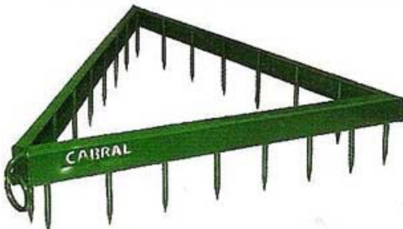
Figura 3. Grade de dentes para o preparo do solo a tração animal.
