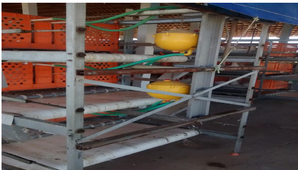
Figura 5 – Esteiras transportadoras automáticas para recolhimento de dejetos
