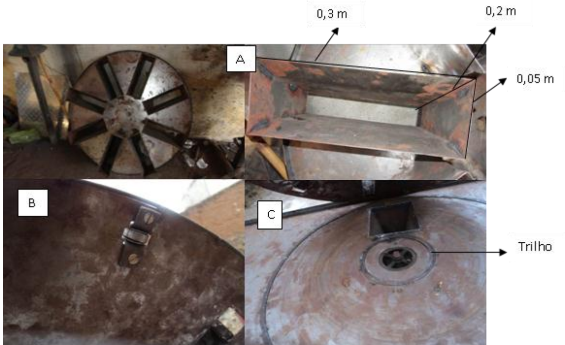
Figura 14-A - Disco dosador, B- Rolamento C- Trilho para o rolamento
