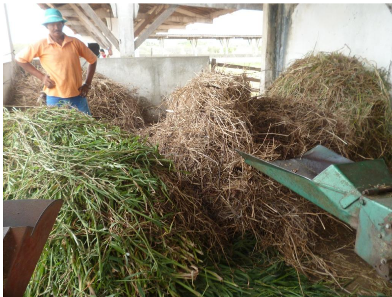
Figura 14 - Uso da desintegradora de forragem sem utilização de EPI
