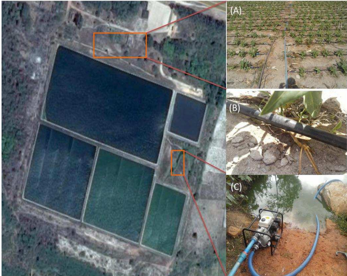
Figura 4 - Estação de tratamento da CAGECE. (A) ilustração do campo experimental com a cultura do feijão-caupi e sistema de irrigação com duas tubulações para os dois tipos de água, (B) gotejador, (C) captação da água de reúso com conjunto motobomba à combustão. Tianguá – CE, 2015
