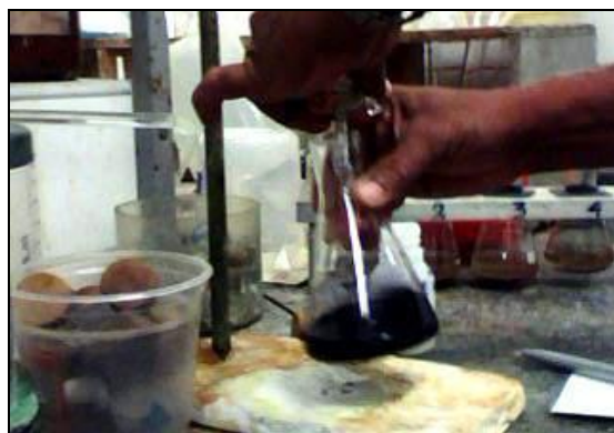
Figura 18 – Processo de titulação das amostras
