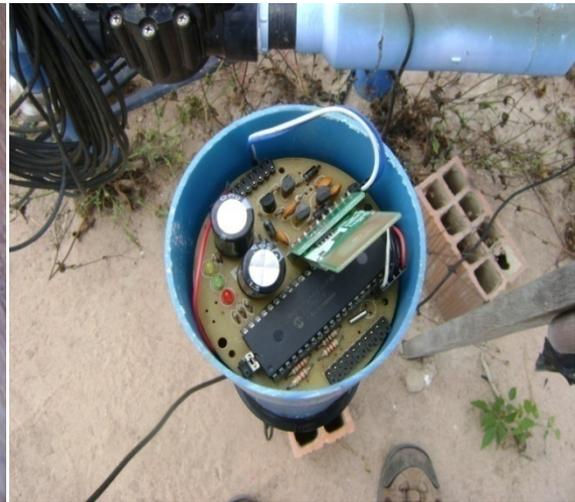
**Figura 15b** – Vista superior da placa base de acionamento das válvulas.
