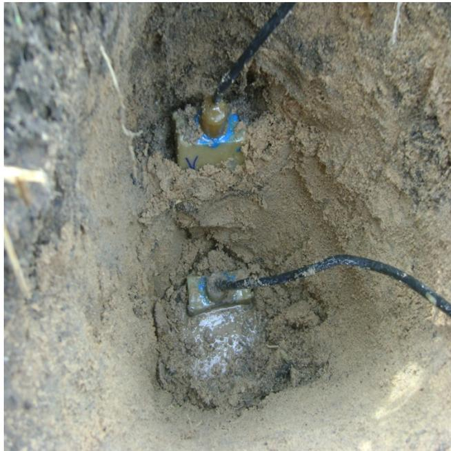
**Figura 7** – Sensores instalados no solo a duas profundidades.
