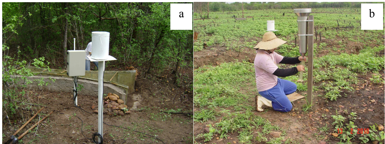
Figura 8 – Pluviógrafo de báscula (a) e pluviômetro Ville de Paris (b) instalados na área de estudo
