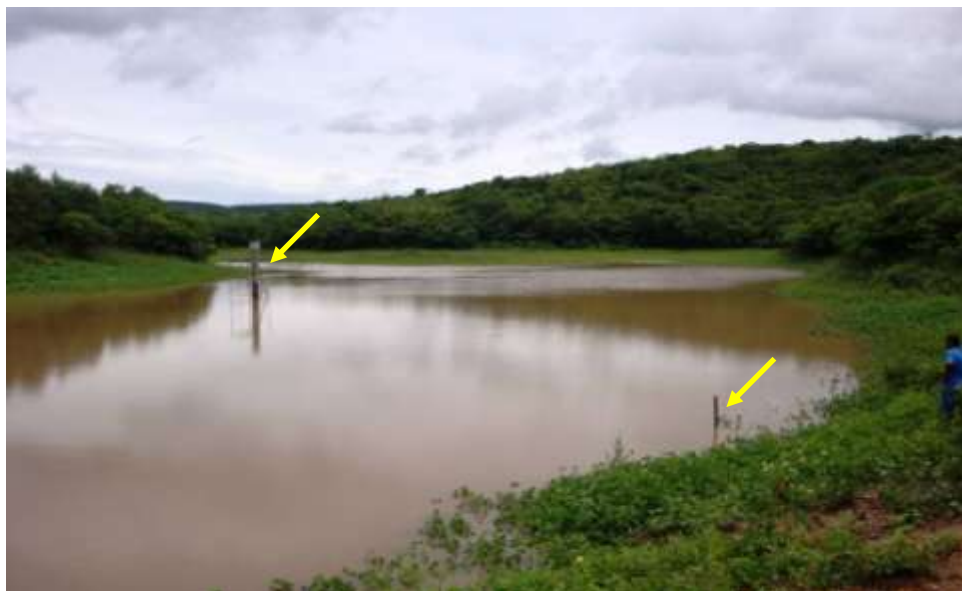
Figura 10 – Açude Boqueirão, exutório da BEA, mostrando localização das réguas linimétricas e Linígrafo. Data: 11/4/2010
