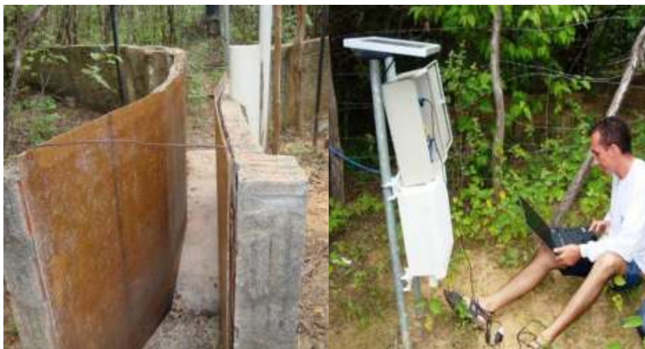
Figura 6 – Estação Fluviométrica 1 (EF1), mostrando a calha Parshall e a coleta de dados para notebook.
