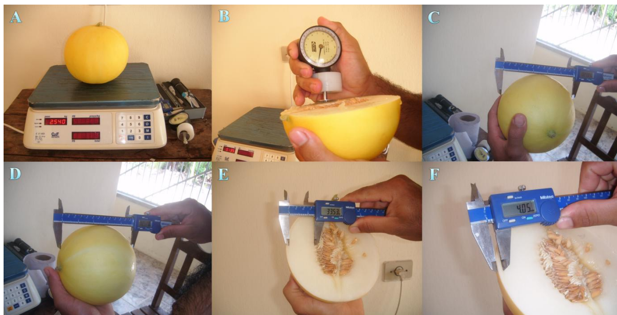
Figura 8 – Pesagem (A) e medições da firmeza da polpa (B), dos diâmetros equatorial (C) e polar (D) e das espessuras da polpa (E) e da casca (F) dos frutos de meloeiro amarelo. Fortaleza, Ceará, 2011.
