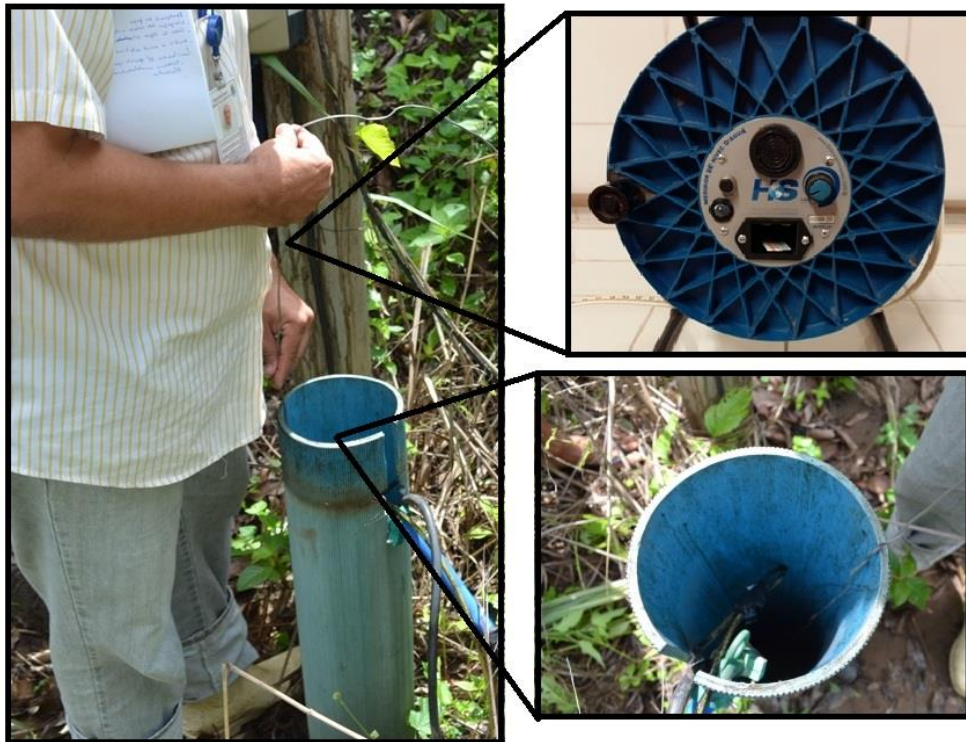
Figura 15 – Medição do nível estático em um poço raso tubular localizado no Perímetro Irrigado Curu Pentecoste
