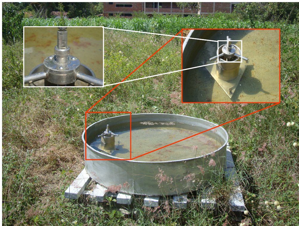
Figura 8 – Foto ilustrativa do tanque Classe “A” instalado na área experimental utilizado para o manejo da irrigação. ETE, Aquiraz, CE, 2009.
