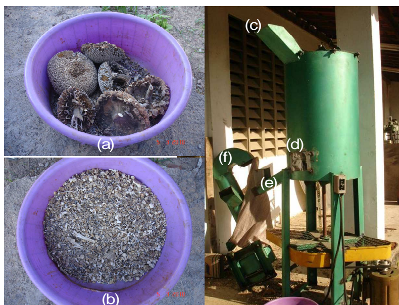
Figura 1 – Foto dos aquênios antes (a) e pos beneficiamento (b). Deatalhes da máquina utilizada no beneficiamento: porta de alimentação (c), gaveta de limpeza (d), saída do material beneficiado (e), peça acoplável para separar aquênios das impurezas (f). UFC, Fortaleza, CE, 2009.
