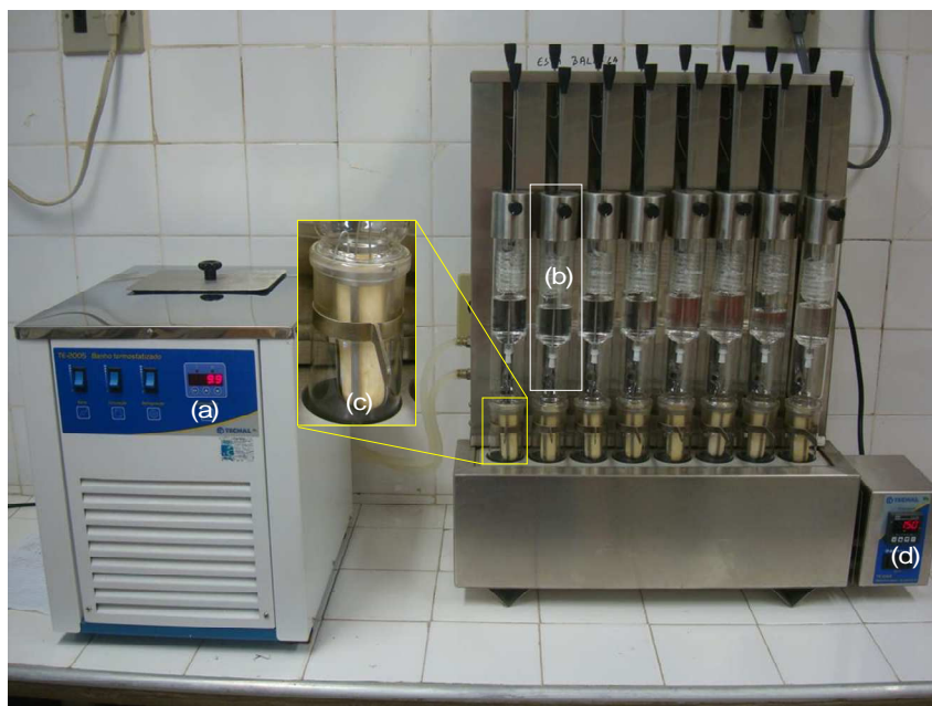
Figura 4 – Esquema do sistema utilizado para determinação do teor de óleo dos aquênios: tempo de banho, temporizador, (a); tubo recuperador do hexano (b); reboiler com amostra de aquênios macerado (c); controlador de temperatura do sistema (d) . Laboratório do Departamento de Fitotecnia da UFC, Fortaleza, CE, 2010.
