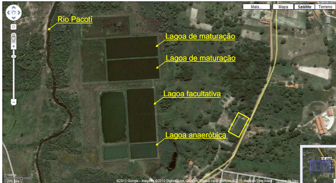
Figura 3- Imagem do rio Pacoti e das lagoas anaeróbica, facultativa e maturação da ETE de Aquiraz, CE, 2009.
