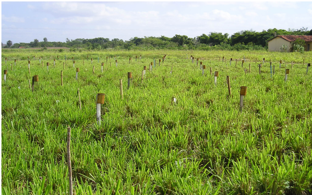
Figura 5 – Detalhe dos coletores para mensuração da água precipitada dos aspersores.
