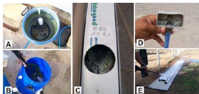
Figura 12. Deposição de sais no reservatório (A); limpeza do reservatório (B); depósito de precipitados na calha e no tampão de saída (C e D); limpeza das calhas (E)
